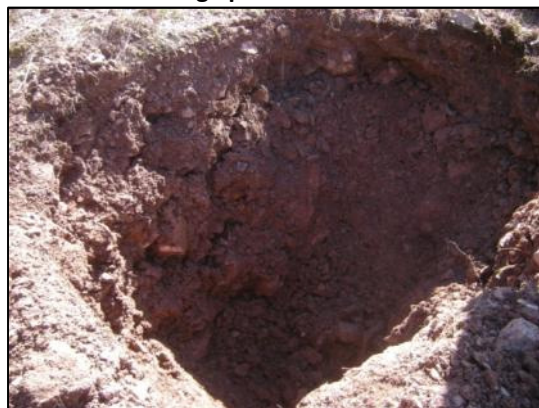
Sondažni razkop R2: nasip iz zaglinjenega gruščča, na dnu razkopa večji skalni bloki lapornatega apnenca.
